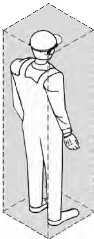
Obrázok 14: Veľkosť únikového priestoru v hornej časti výťahovej šachty (výška 2000 mm)
